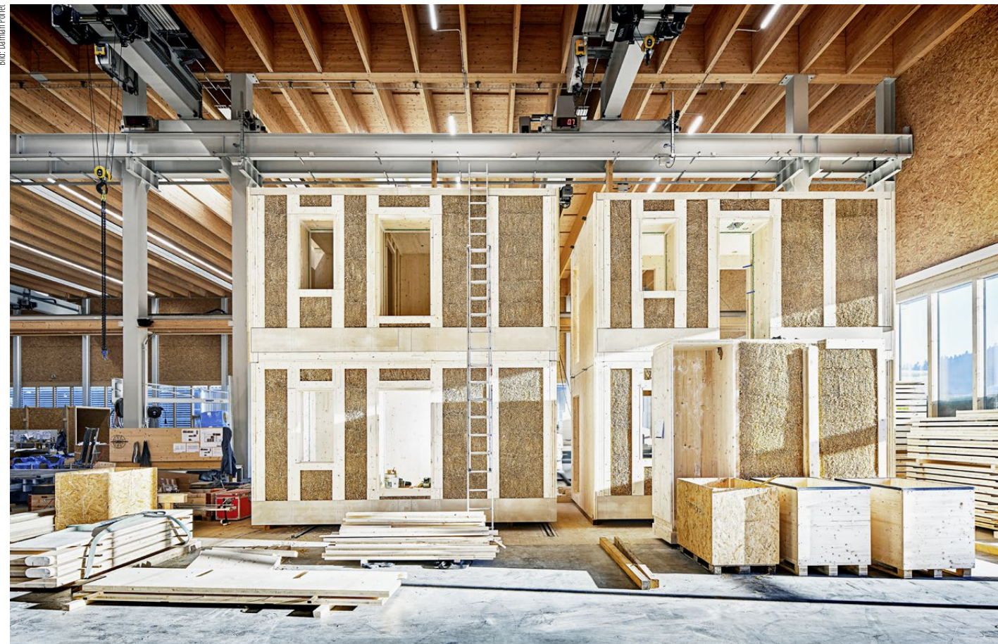
Die 68 Module für die Strohballenhaus-Siedlung in Nänikon ZH fertigt die Zaugg AG Rohrbach an ihrem Standort im Berner Oberaargau vor.
