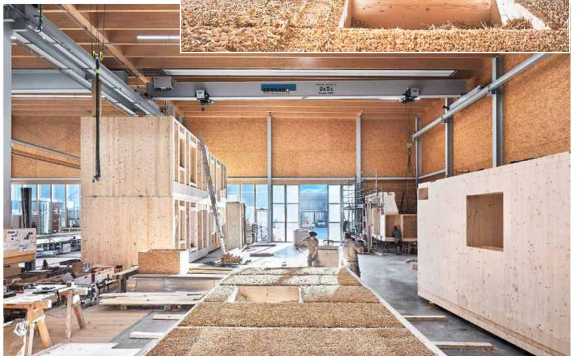
Tragende Struktur der Strohballehaus-Siedlung bilden 68 vorgefertigte Holzmodule, die mit 420 Tonnen Strohbällen gefüllt sind. Gefertigt werden sie von der Zaugg AG Rohrbach. BILDER DAMIAN POFETT
